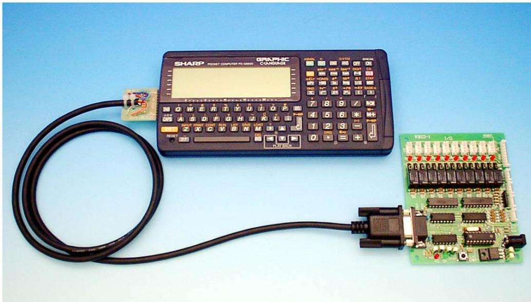
11ピン全てがポケットPC側の穴に入れば接続完了です。1本ずれた状態では、通常挿入できませんが、無理に強行すると端のピンを曲げて挿入されてしまいます。
